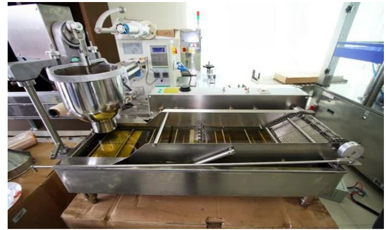
ภาพการทอดโดนัทที่มีอุณหภูมิคงที่
